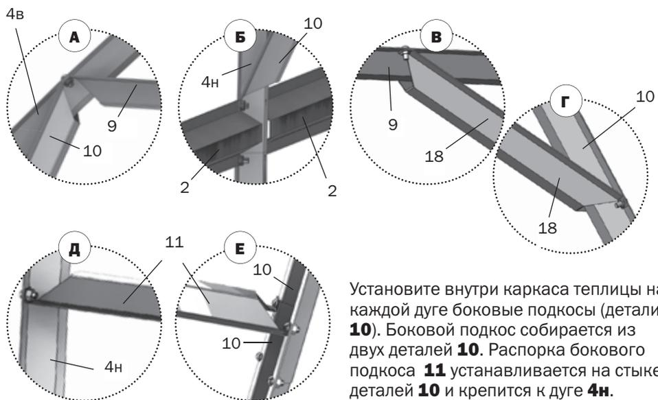
Установите внутри каркаса теплицы на каждой дуге боковые подкосы (детали **10**). Боковой подкос собирается из двух деталей **10**. Распорка бокового подкоса **11** устанавливается на стыке деталей **10** и крепится к дуге **4н**.
