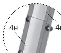
Закрепите дуги **4h** к дугам **4v** с одной стороны теплицы.
