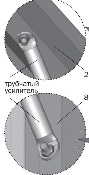
Установите трубчатые усиленители дверного проема в соответствии с рис.25
