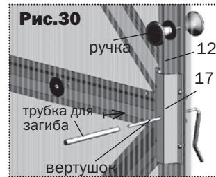
состоянии с помощью трубы выполняется загиб прямолинейной части рукой в противоположную сторону (рис. 31). Установить на вертушок эластичные насадки (рис. 32). Такая
